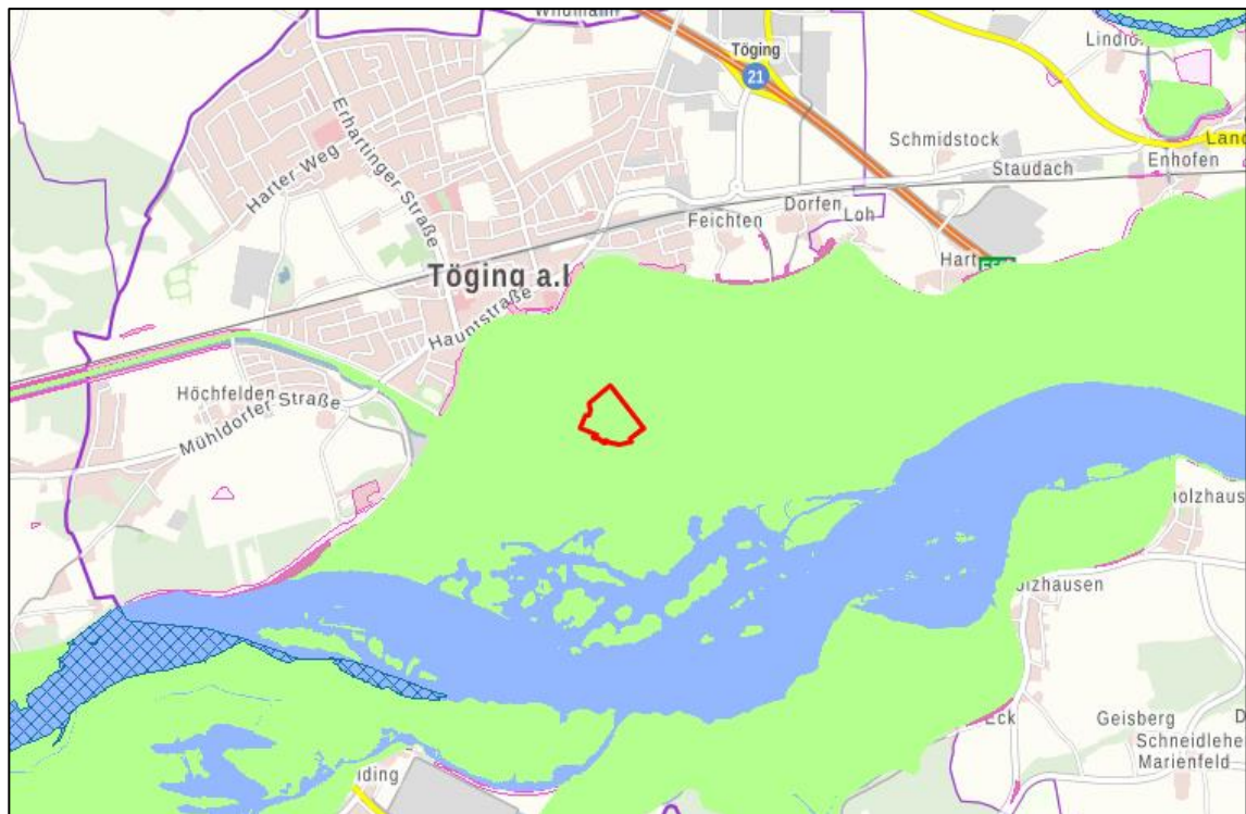
Abb. 10 Thema Hochwasser im Untersuchungsgebiet. Blau: Wassertiefen für HQextrem (je dunkler desto tiefer), grün: wassersensible Bereiche. Geobasisdaten: © BVV. Geofachdaten: © LfU. Quelle: BayernAtlas, Zugriff am 04.05.2023.
